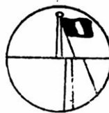
Schéma montrant la coïncidence ou la non-coïncidence des images dans le télémètre Barr et Stroud. La correction faite on prend la moyenne de dix lectures.
