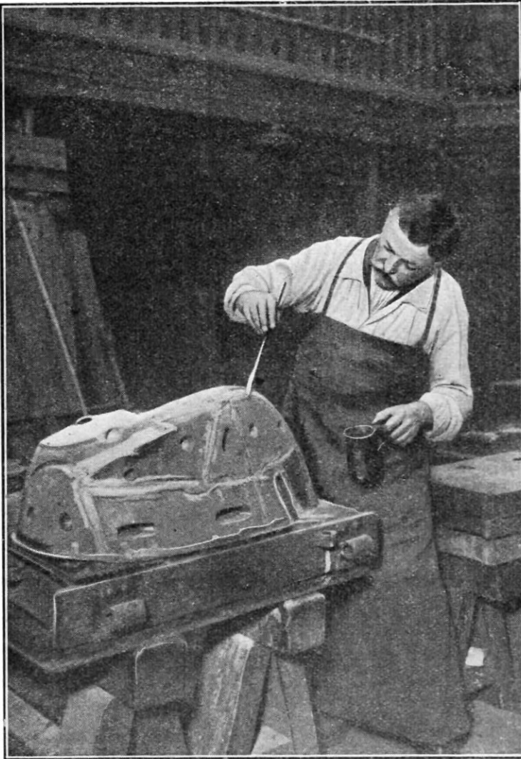
LA PRÉPARATION D'UN MOULE POUR PETITE STATUE
