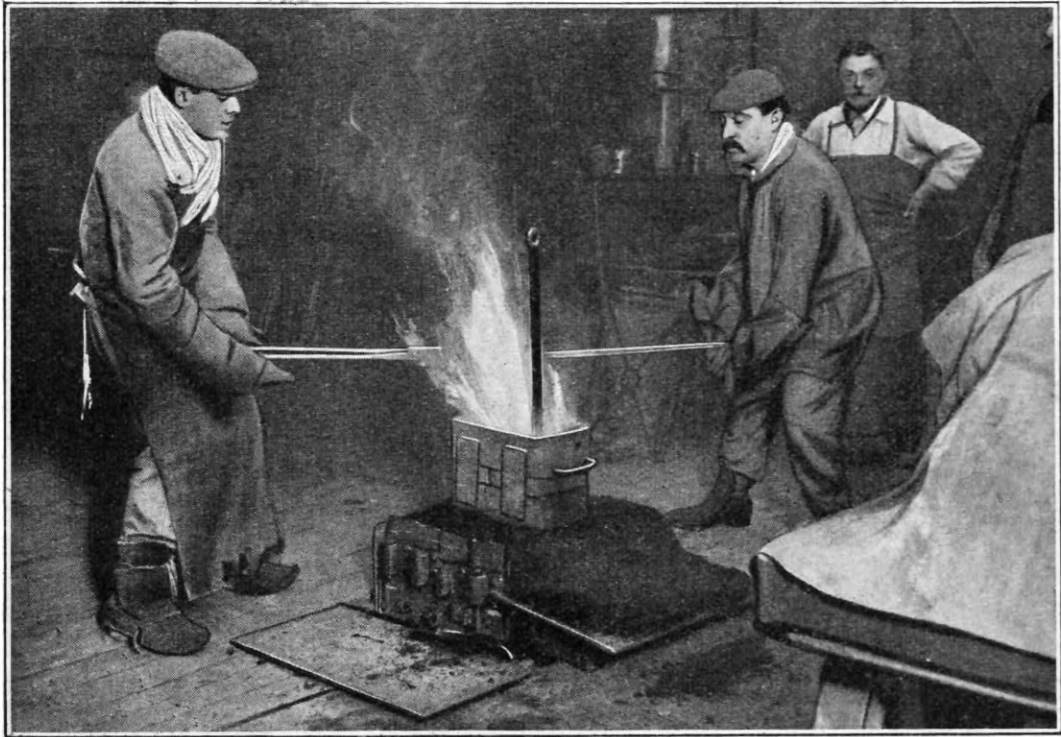
CETTE PHOTOGRAPHIE REPRÉSENTE LA COULÉE D'UNE PETITE PIÈCE Les bibelots d'étagère sont souvent fondus par série, c'est-à-dire plusieurs ensemble dans le même châssis
